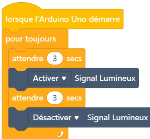
**Remarque** : le programme ne peut s'arrêter lorsqu'il est dans une boucle infinie. Le seul moyen de sortir de la boucle est de faire un Reset ou d'éteindre et rallumer le boîtier AutoProg.
