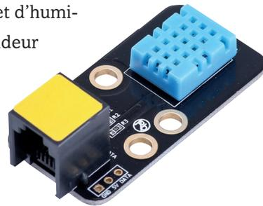
capteur d'humidité sur le Port 1 humidité
