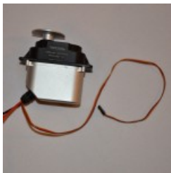
MAMMOTH Alimentation 2 fils de puissance plus 3 fils pour le pilotage
