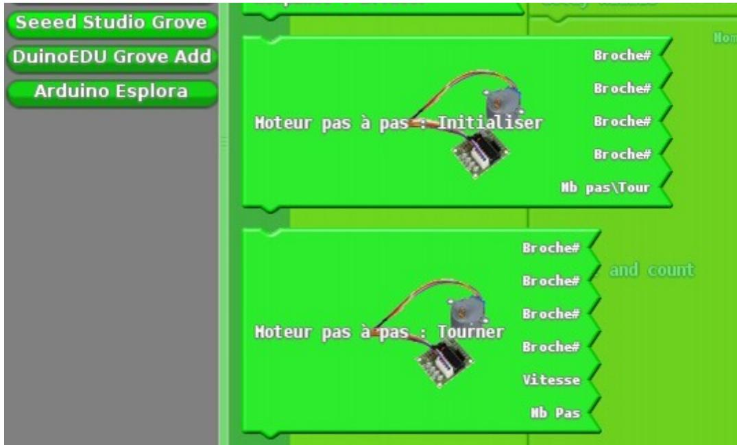
Pour la programmation des moteurs pas à pas , il faut d'abord initialiser le moteur avec les broches qui vont bien. Si vous avez raccorder les broches 4,5,6,7, il faut indiquer dans les parties broches du module : 4,6,5,7 pour respecter les phases du moteur.
