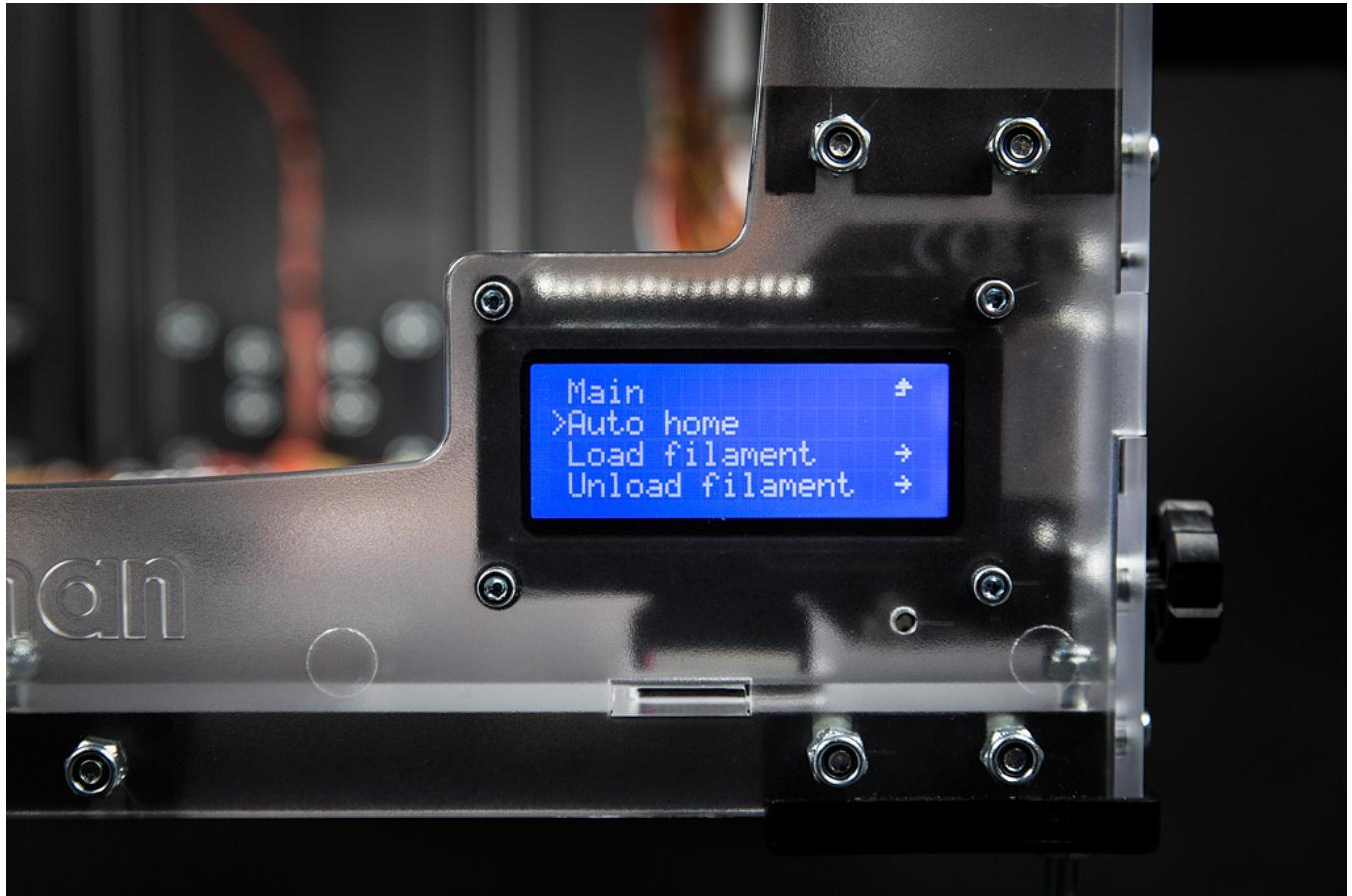
Si tout se passe correctement, la tête se positionnera en position "park" (arrière droite) et la plate-forme de construction montera et s'arrêtera lorsqu'il y aura **environ 3 mm d'espace entre la plateforme de construction et la/les buse(s)**.
