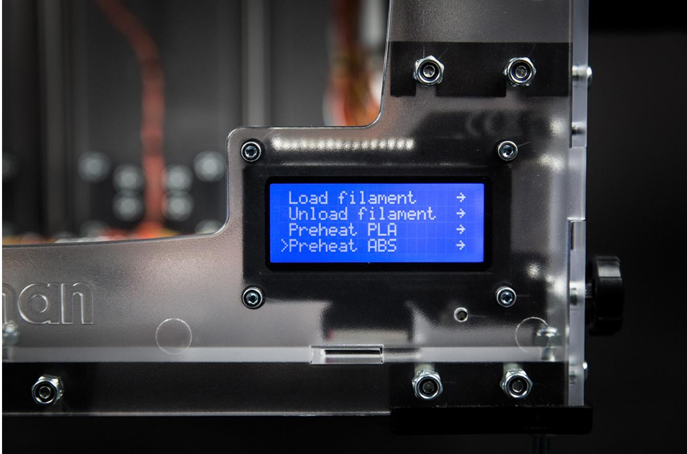
Cette option vous permet de préchauffer chaque buse et un lit chauffant si celui-ci est lié à une température associée au filament d'ABS. Ces températures peuvent être modifiées et enregistrées dans la mémoire interne, mais cela sera expliqué dans le menu PARAMETRES (SETTINGS).
