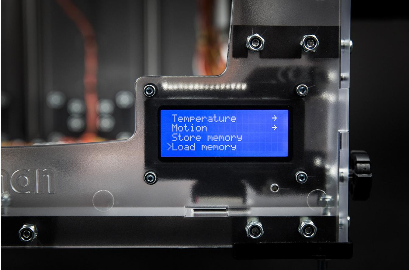
La 6e option du menu PARAMETRES (SETTINGS) est **RESTAURER LE REGLAGE D'USINE** (RESTORE FAILSAFE). Cela vous permet de charger tous les réglages d'usine contenus dans la mémoire EEPROM du microcontrôleur. **Cette commande supprime toutes les modifications utilisateur effectuées dans le menu de paramétrage !**
