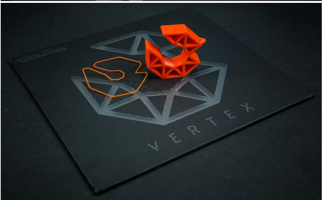
Quelques impressions sont nécessaire (2 ou 3, en fonction de la taille de l'objet) pour que la buse s'adapte. La qualité de la surface de l'impression sera visiblement meilleures après ces premières impressions.
