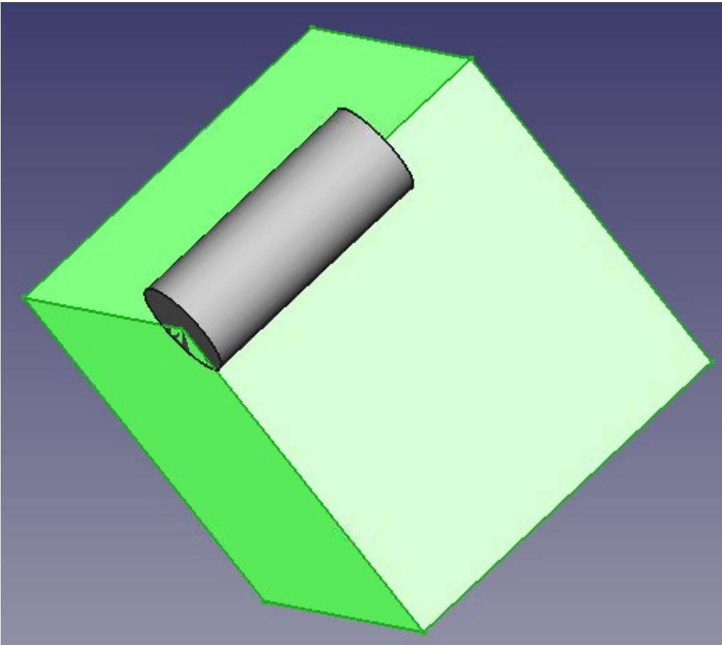
Sélectionner l'objet et l'allonger à 25mm puis le centrer sur la face X,Y à l'aide de l'onglet données :
