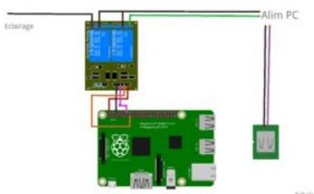
L'avantage du double relais est qu'il peut du coup commander autre chose (par exemple moi il contrôle l'éclairage de la cam).
