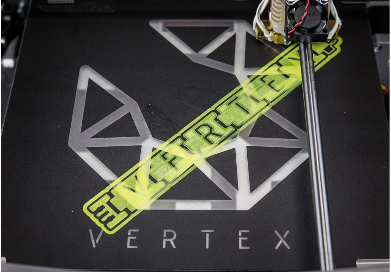
Lorsque la première couche dans un matériau est terminée, la tête d'impression se déplace vers le centre-gauche et commence à chauffer la seconde buse. Les ventilateurs sur la tête d'impression devrait commencer le filage. Vous pouvez remarquer la petite collerette dans le coin supérieur gauche, pour la tour d'essuyage.
