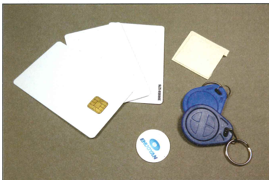
Petit échantillon de différentes formes que peuvent prendre les tags RFID : stickers, porte-clé, carte...
