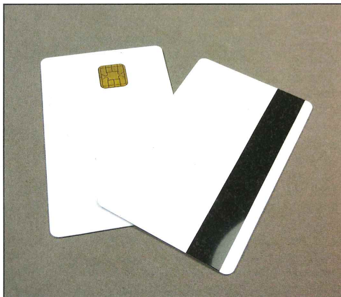
Les cartes RFID peuvent être des supports combinant plusieurs technologies. Ici des cartes DESFire avec une « puce JCOP » et une piste magnétique.
