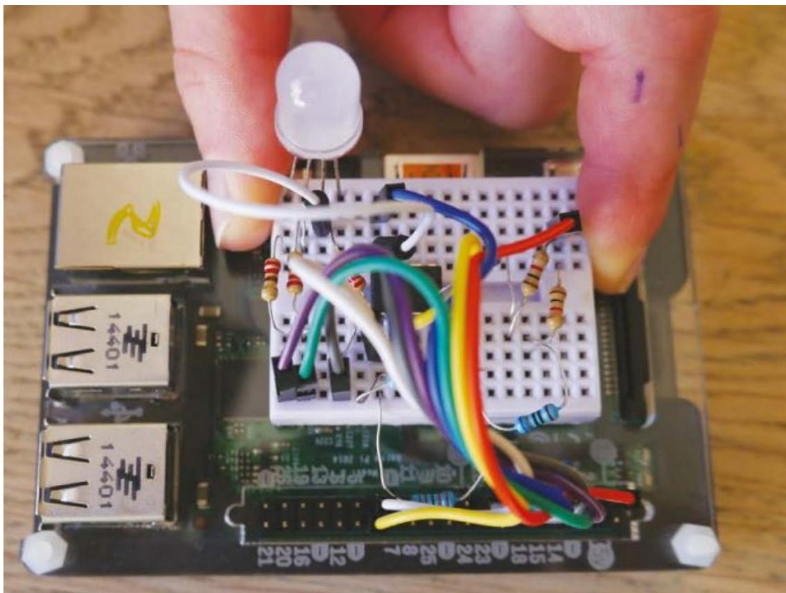
Testez le fonctionnement du prototype sur une plaquette de câblage rapide, en exécutant le code Python proposé.
