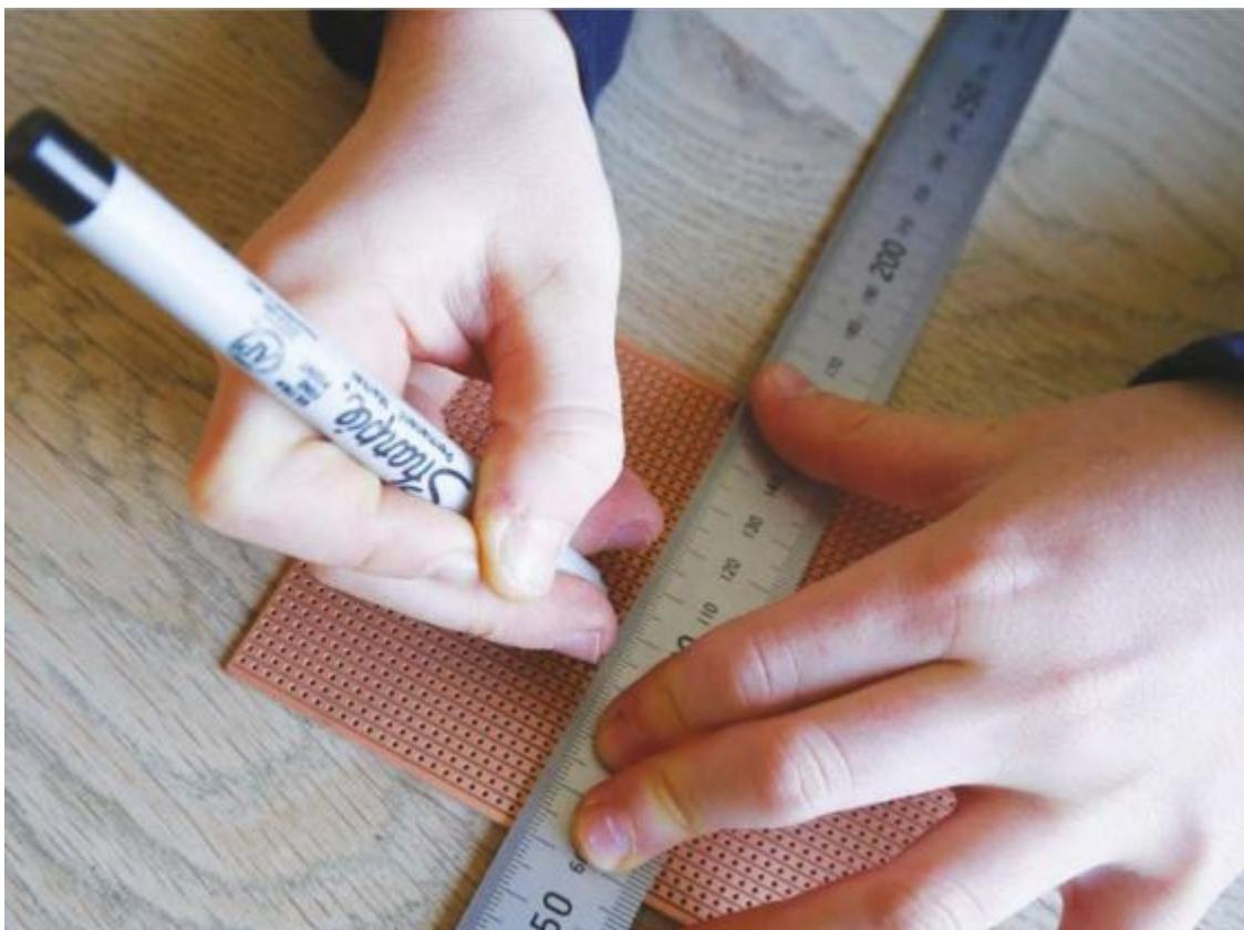
*Découpez un morceau de plaque veroboard à la bonne taille, de façon à recouvrir la surface du Pi avec la carte HAT.*
