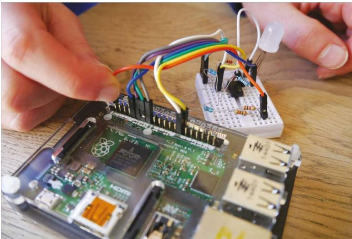
*Faire d'abord un prototype de circuit sur une plaquette de câblage rapide ou un Explorer HAT permet de s'assurer que tout fonctionne et de faire des ajustements rapides.*
