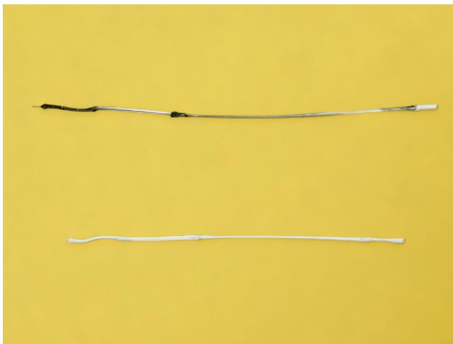
Premier tirage à froid (en haut) et après plusieurs tirages à froid (en bas)
