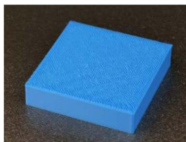
Débordement de la couche supérieure (surextrusion)
