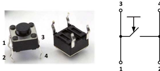
Figure 5.50 Petit bouton et schéma de raccordement
