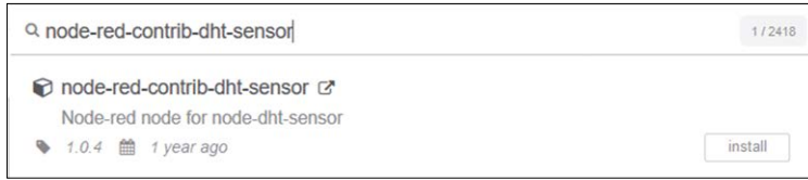
Figure 6.22 Installation du nœud DHTxx
