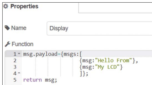
Figure 6.6 Contenu du nœud de fonction
