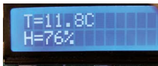
Figure 11.34 Affichage de la température et de l'humidité
